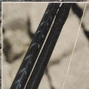
Das untere Blank-Teil (links) wurde mit Kreuzwicklungen versteift
