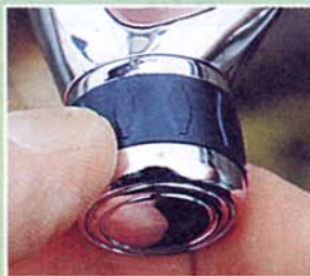
Heckbremsknopf mit Gummi-Ummantelung
